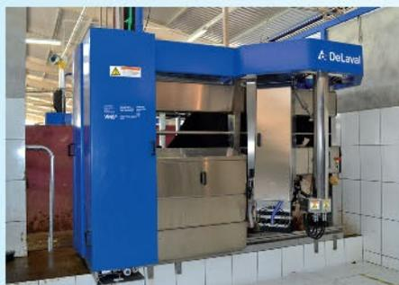
**ROBÔ.** Modelo de máquina para ordenha totalmente automatizada
