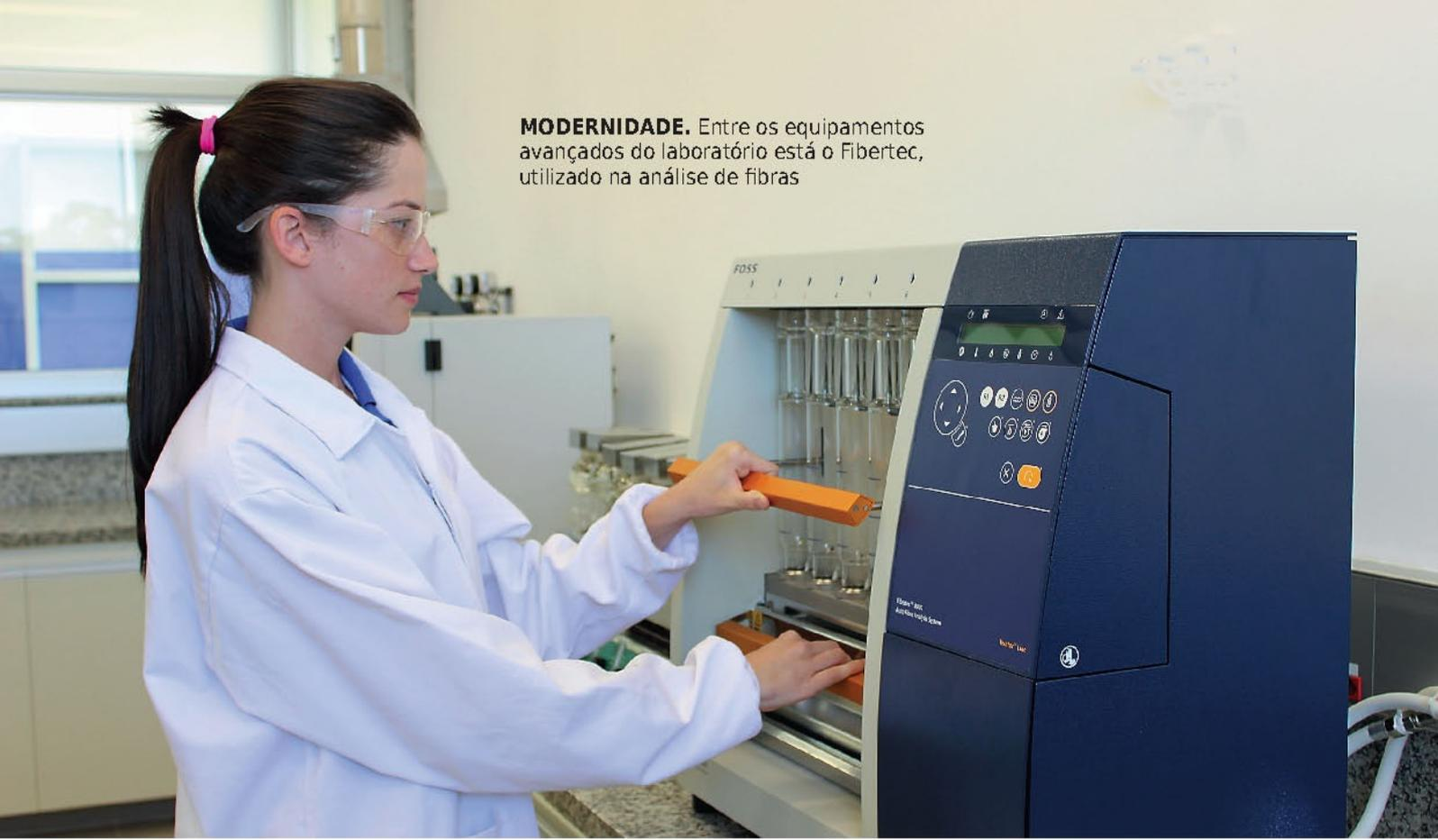
**MODERNIDADE.** Entre os equipamentos avançados do laboratório está o Fibertec, utilizado na análise de fibras
